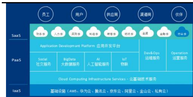
图表26. 金蝶云·星空三级架构图
