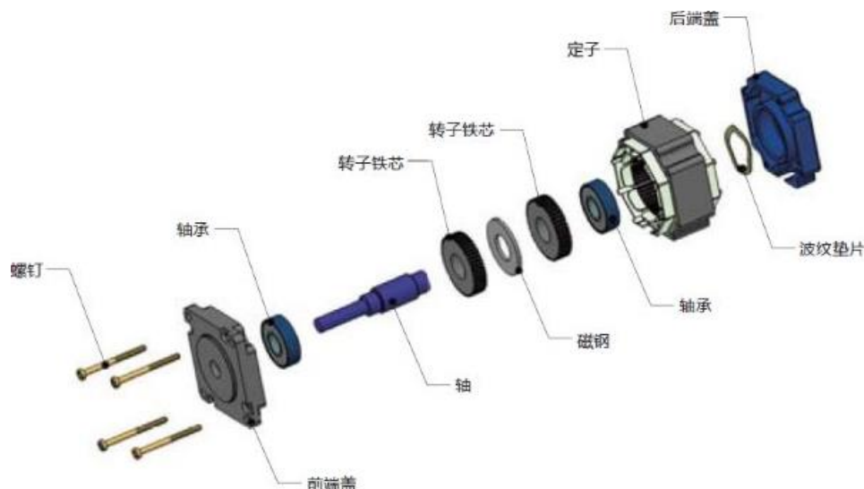
图 10：步进电机结构
