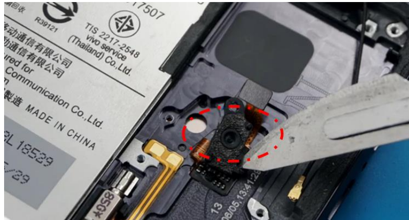
图 17: VIVO NEX 屏下指纹摄像头方案结构
