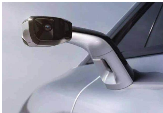
图表 82：摄像头代替物理镜面方案
