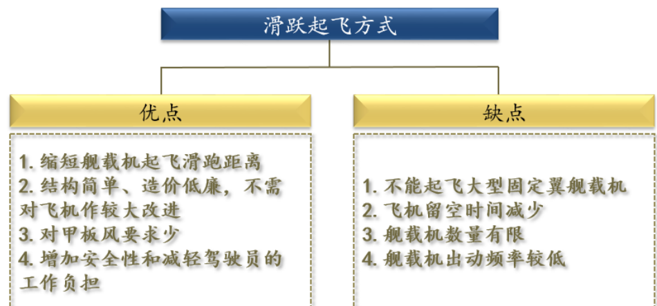
图8：滑跃起飞方式优缺点
