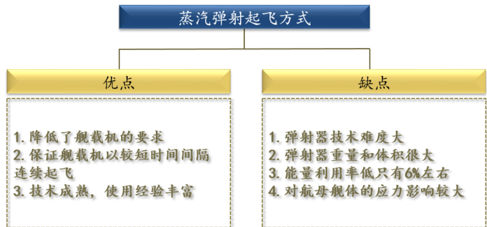
图9：蒸汽弹射起飞方式优缺点
