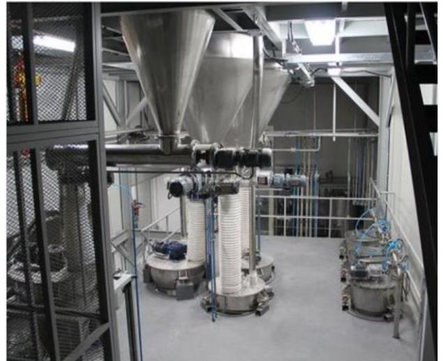
图 59: 金银河锂电电子电池全自动配料系统
