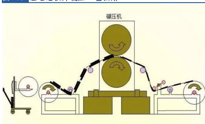
图 13: 锂电池极片辊压工艺图解
