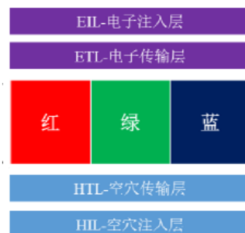
图 14: OLED 面板有机层结构示意图
