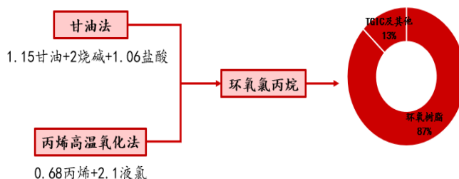
图 55: 环氧氯丙烷生产工艺及产业链
