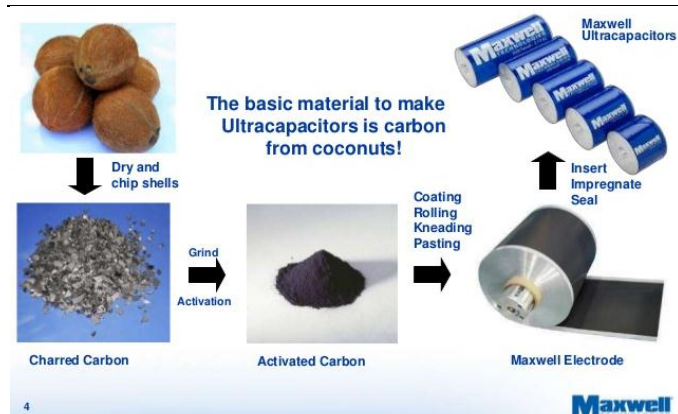
图 16: Maxwell 干电极技术在超级电容器上的应用
