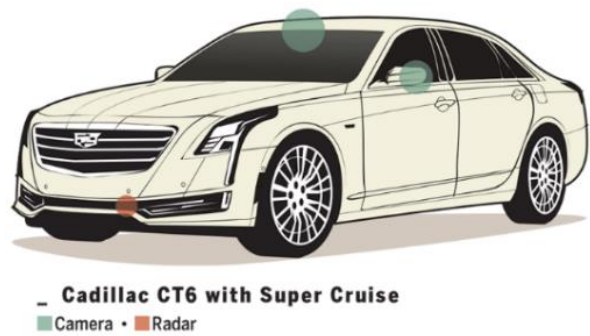
图 12: 凯迪拉克 CT6 Super Cruise 传感器配置
