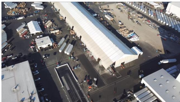
图 21: Tesla 在厂房室外搭建“帐篷”增加一条装配线 GA4
