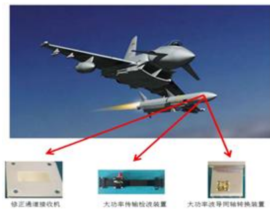
图 6: 弹载雷达微波射频前端核心组件
