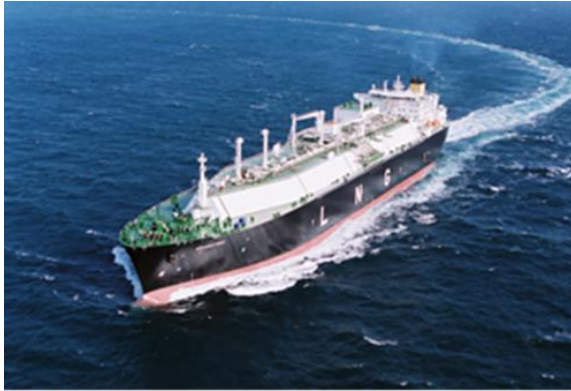
图 55：薄膜式 LNG 运输船（储罐与船为一体）
