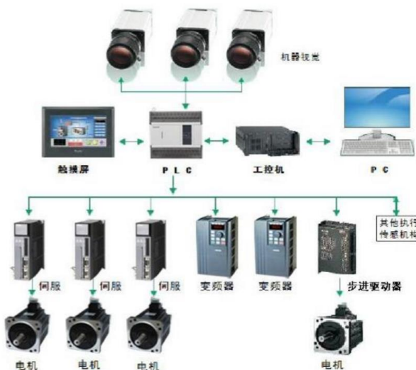
图表 46：信捷电气整体工控自动化解决方案示意图
