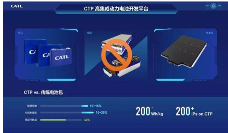
图22: 宁德时代 CTP 技术实现电池包零部件减少 40%，能量密度提升 10%+
