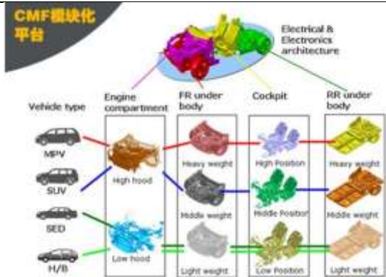
图 42: 雷诺-日产 CMF 模块化平台
