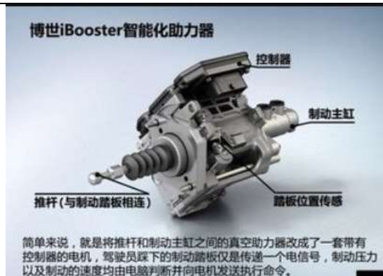
图 52: 博世智能刹车系统 IBS
