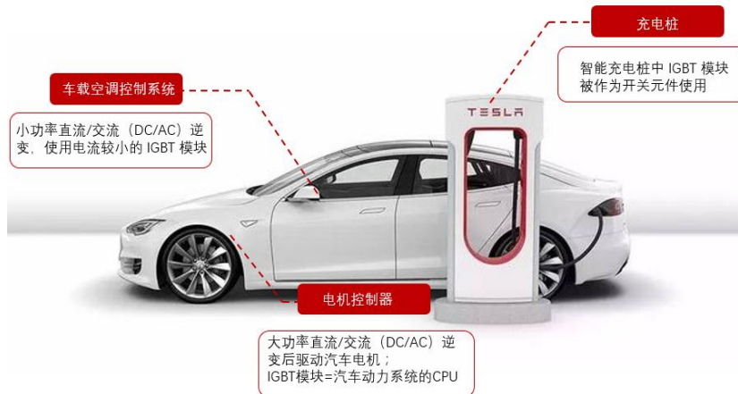
图 27：IGBT 在新能源汽车中的应用
