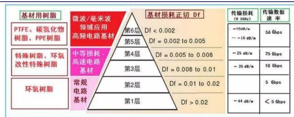
图 5、不同板材的传输损耗和速率不同
