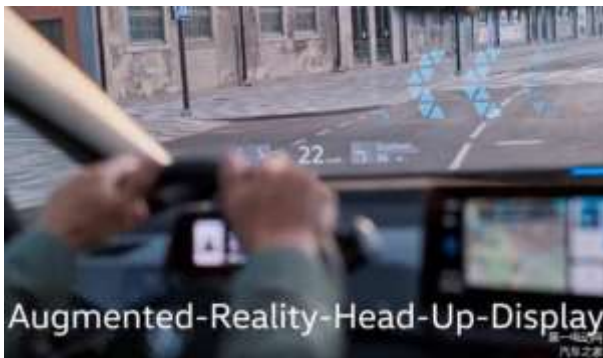
图 17: ID.3 的 AR-HUD 导航示意图
