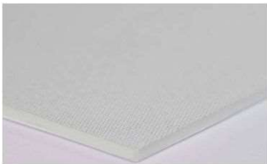
图 3：光伏玻璃的压花表面
