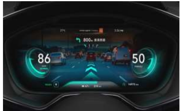
图 18: AR-HUD 导航示意图
