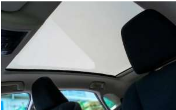
图 19：汽车调光玻璃的雾化模式
