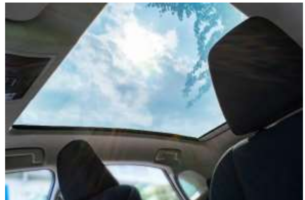
图 20：汽车调光玻璃的透射模式
