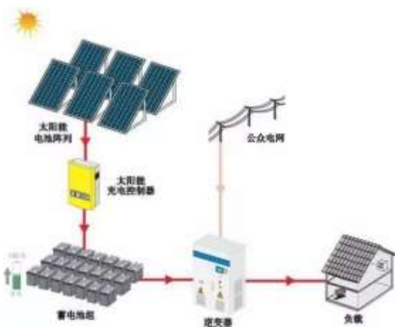
图 19: 光伏发电基本原理
