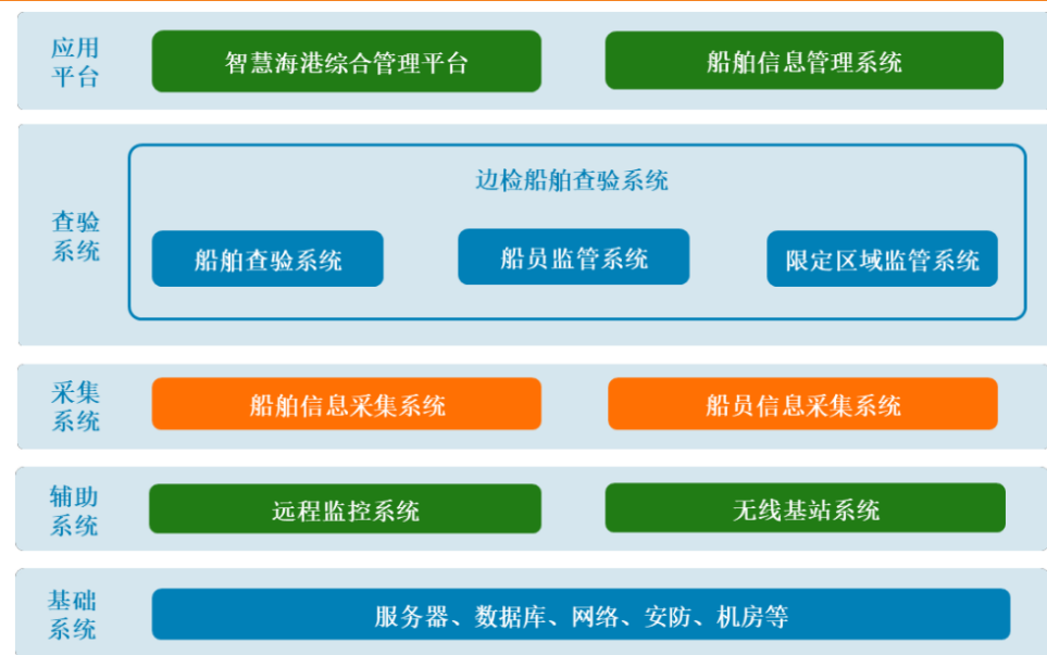
图 5：船舶查验系统架构图
