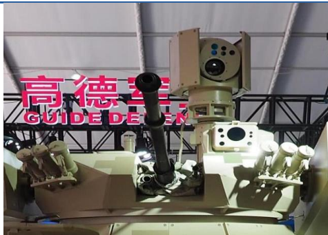
图 36: 炮塔中央的 30 毫米机关炮和 7.62 毫米机枪
