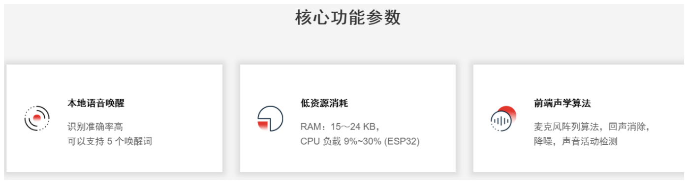
图 3：乐鑫科技 ESP 32 AI 语音交互方案的核心功能参数
