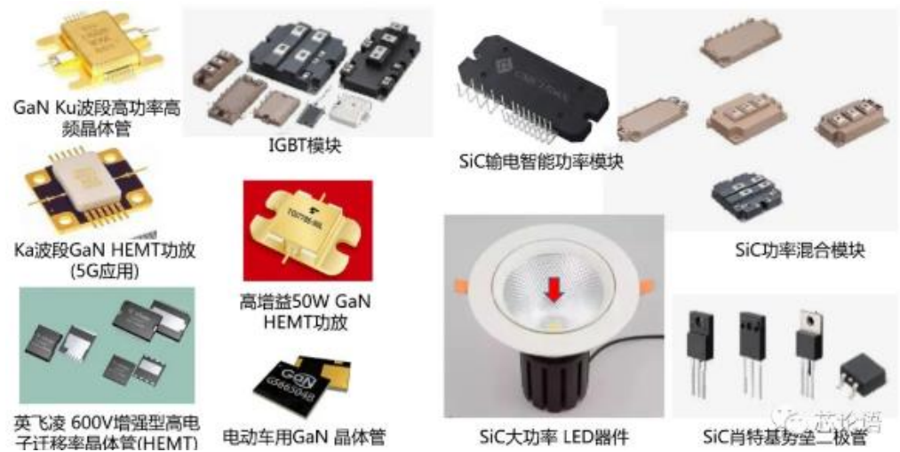
图表29：氮化镓(GaN)、碳化硅(SiC)材料制作的电子器件和芯片
