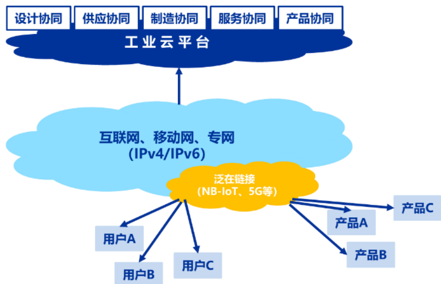
图 11：5G 协助工业互联网工厂外网络实现产业链的泛在链接
