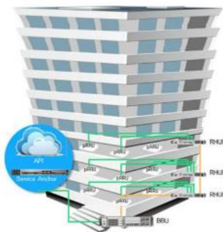
图 15: 小基站产品 Lampsite 补充覆盖楼宇
