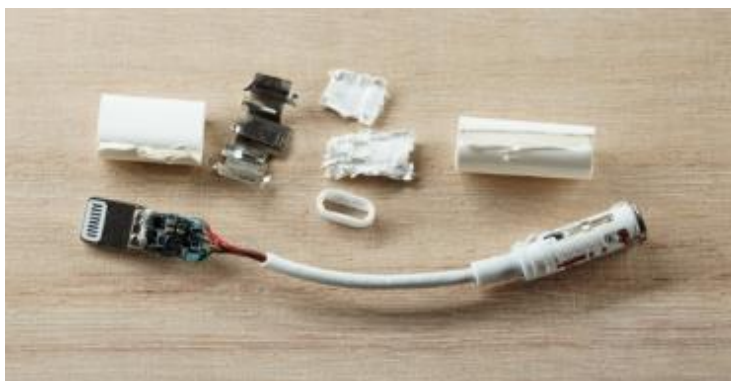
图 4：Lightning to Audio 转接线将手机内部 DAC 移转接线中
