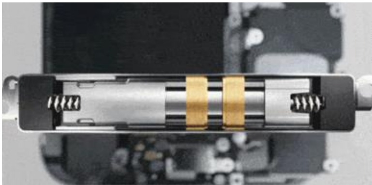
图 5：Taptic Engine 结构图，工艺精度要求高
