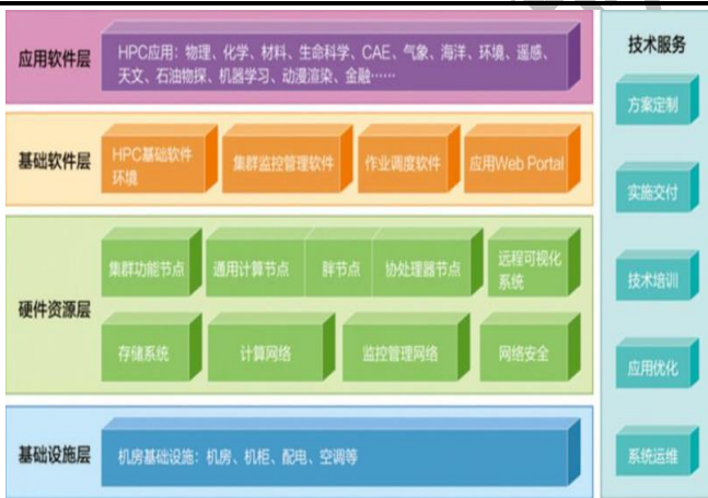
图表41：中科曙光6000系列高性能计算架构
