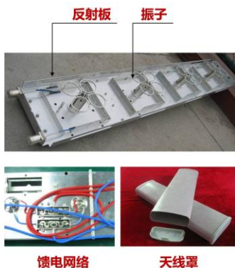
Figure 24 传统天线仅由振子、馈网、反射板、天线罩组成
