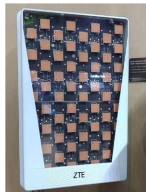
Figure 17 中兴通信 Massive MIMO 天线
