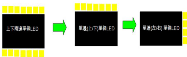
图 29：侧光式背光的优化路径
