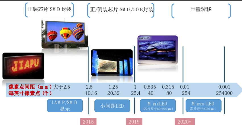
图 9：小间距、Mini LED、Micro LED 三种间距区别
