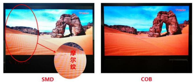
图 14: SMD 封装与 COB 封装的显示效果对比
