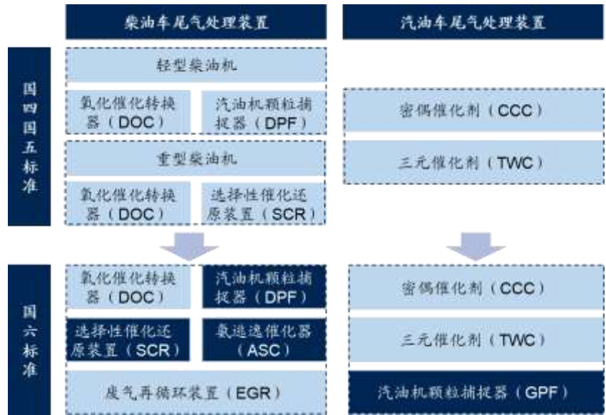
图 71：国六标准尾气处理装置变化
