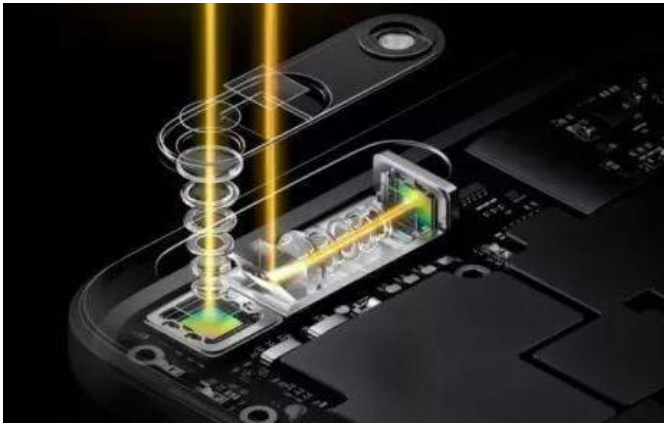
图表 49: 潜望式摄像头与传统镜头结构差别
