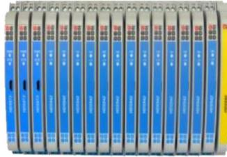
串联在信号线上，在不影响信号和通讯的条件下，将可能进入危险场所的能量（电能）限制在安全值以下，保证现场安全。满足 Exia Ga IIC 防爆等级要求。获得中国船级社、SIL2、SIL3、CE 认证。采用先进的低功耗电路设计；并采用端子间对流散热孔设计，带来完善的热流道，散热更充分。
