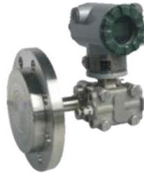
将压力/差压信号转换为标准电信号的高精度、高稳定性工业现场仪表，采用单晶硅复合压力传感器，可测量气体、液体和蒸汽的压力、流量和液位。获得防爆合格证、CE、SIL2 认证，支持现场总线通讯和无线通讯方式。
