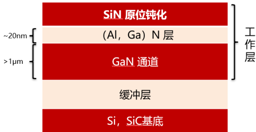
图表：GaN射频器件结构示意图
