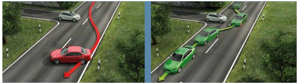
图9 汽车 ESP 工作原理
