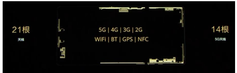
图 21: Mate 30 Pro 搭载 21 根天线
