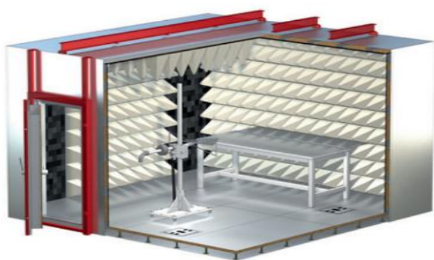
图 25：微波暗室构造
