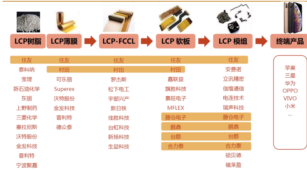
图 34：LCP 电子元器件生产流程及竞争格局
