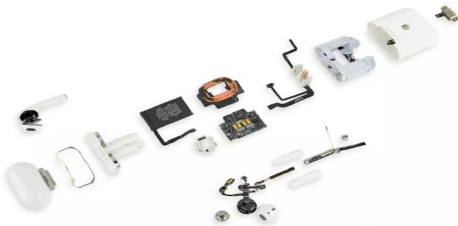
图 60: AirPods 内部结构
