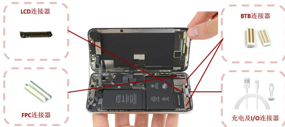
图 18：手机内主要连接器示意图
