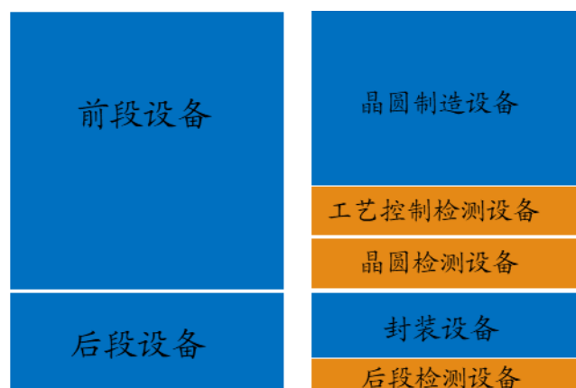
图8：检测设备在前后段的应用
