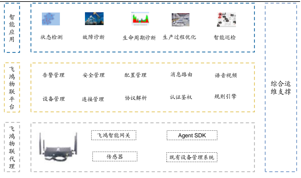
图 30: 飞鸿物联平台架构
