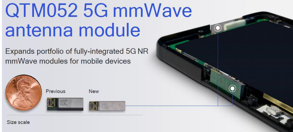
图 29 高通毫米波模组嵌入金属边框的设计
