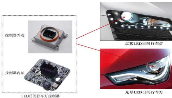
图4 LED 辅助光源控制器
