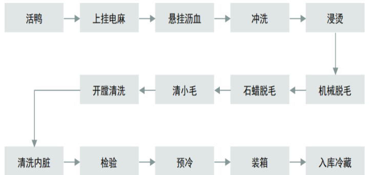
图 17: 公司冰鲜鸭生产工艺流程
