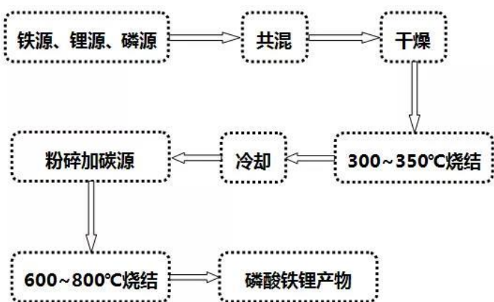
图表 40 贝特瑞固相法工艺流程
