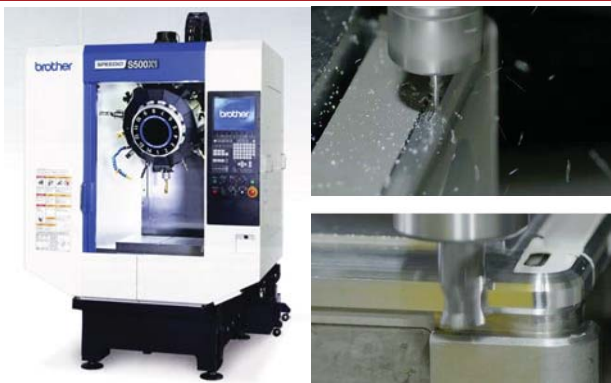
图 35：CNC 机台与加工示意
