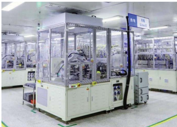
图 47: 公司自研玻璃热弯设备
