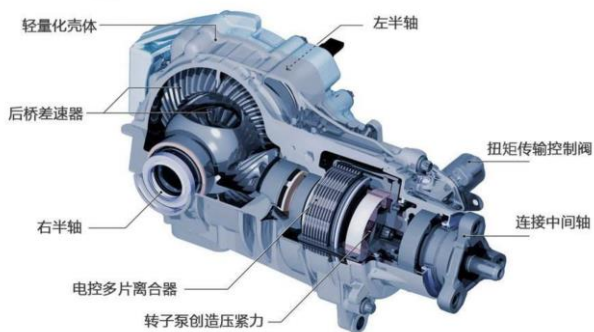
图 14：变速器总成
