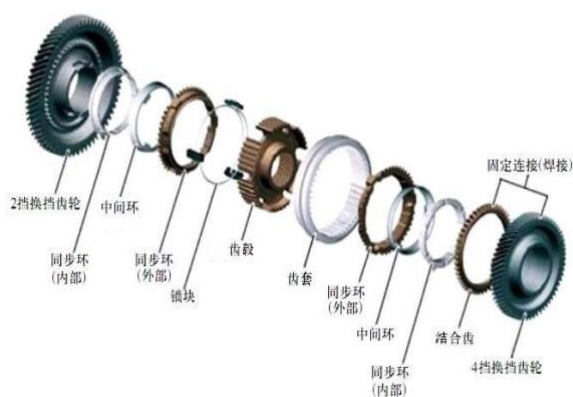
图 7：汽车变速器用同步器主要构成
