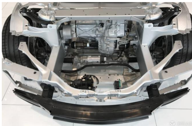
图 19：特斯拉 Model S/X 的底盘和电驱动系统
