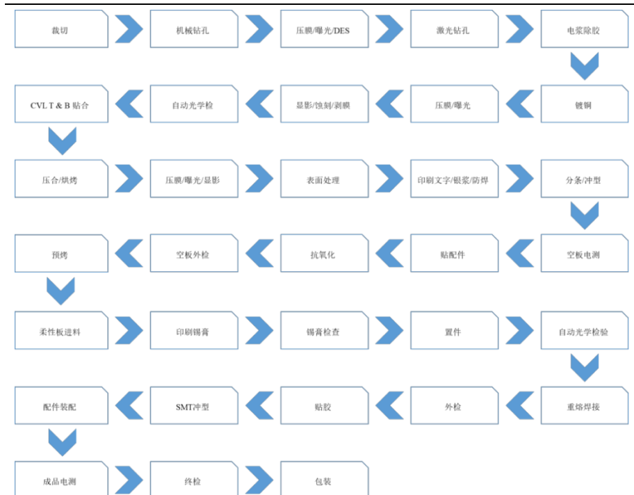
图表 16：FPC 制作工艺流程十分复杂
