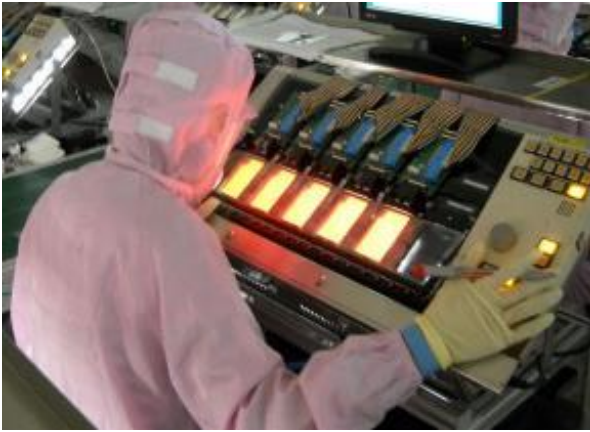
图表 46: 面板人工目检示意
