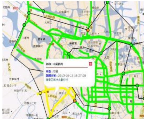
图 29: 上海肯特管网漏损管理系统
