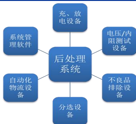
图 9：锂离子电池生产线后处理系统的构成
