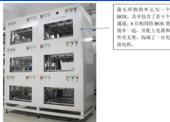
图 10：充放电机的构成
