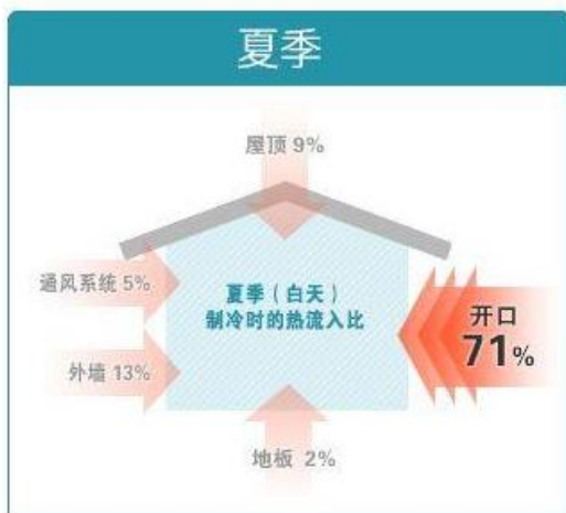
图 20：夏季建筑物热量交换模拟图
