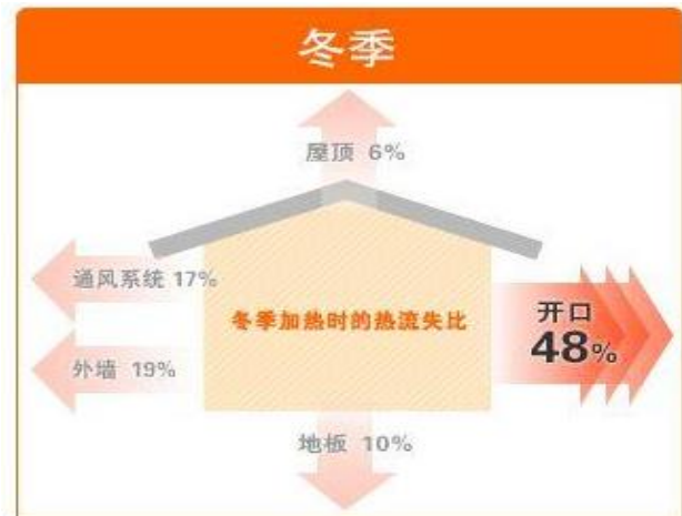
图 21：冬季建筑物热量交换模拟图
