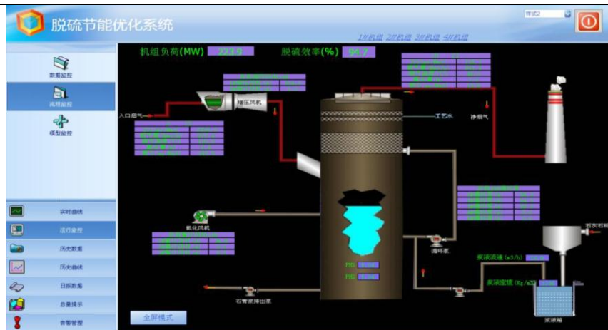
图4 公司研发的脱硫节能优化系统
