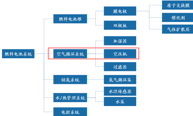
图19: 燃料电池汽车五大系统构成
